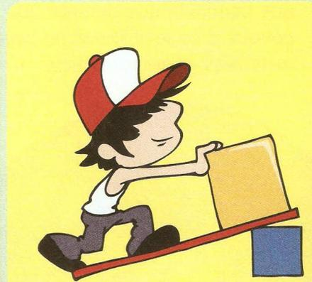
El **plano inclinado** es una superficie plana que forma un ángulo agudo con el suelo y se utiliza para elevar cuerpos a cierta altura.
