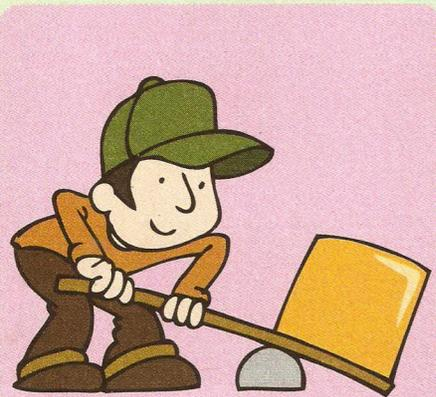
La **palanca** está compuesta por una barra rígida que puede girar libremente alrededor de un punto de apoyo.
